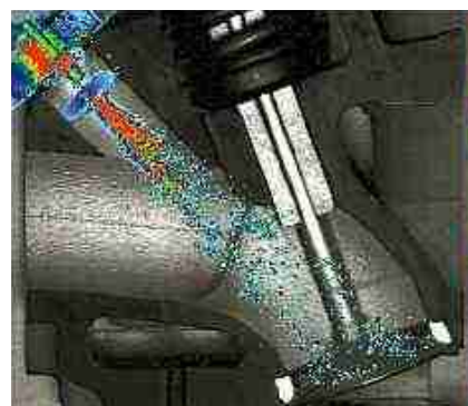
В эксперименте в Национальных лабораториях в Сандии распыленное топливо (окрашено) из форсунки попадает на открывающийся впускной клапан.
